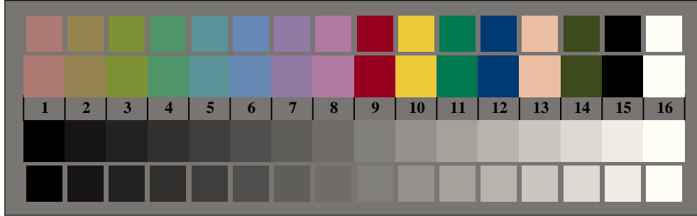
Bild B3: 14 CIE-Prüffarben sowie 2 + 16 Graustufen; Benutzung des PS-operators olv* setcolor / w* setgray
