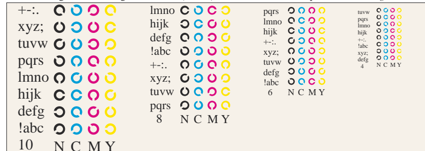
Bild B5: Schrift und Landoltringe N, M, C und Y; Benutzer PS-Operator olv* setrgbcolor / w* setgray
