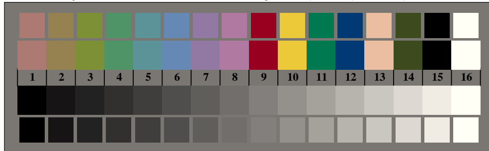
Bild D3: 14 CIE-Prüfbarben sowie 2 + 16 Graustufen; Benutzung des PS-operators cmy0* setcmycolor (only)
