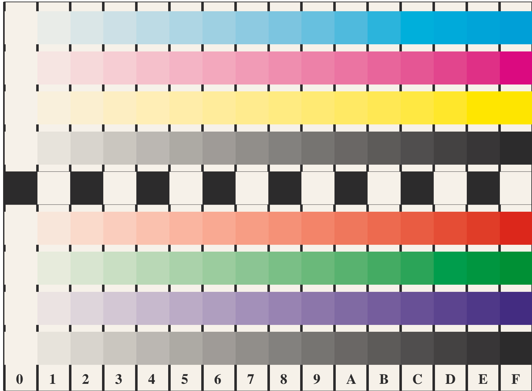
Bild B4 und D4 der ISO/IEC-Prüfvorlagen Nr. 2 und 4; 16 visuell gleichabständige Stufen von Farbreihen; Benutzung des PS-Operators LAB* setcolor
