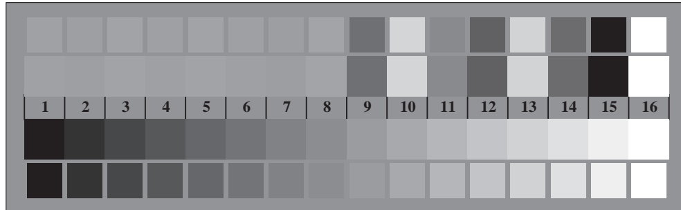
Bild B3: 14 CIE-Prüfbarben sowie 2 + 16 Graustufen; Benutzung des PS-operators olv* setcolor / w* setgray
