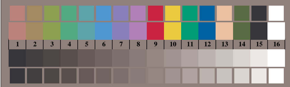
Bild D3: 14 CIE-Prüfbarben sowie 2 + 16 Graustufen; PS-operator cmy0* setcmykcolor (only)
