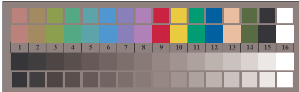
Bild B3: 14 CIE-Prüfbarben sowie 2 + 16 Graustufen; PS-operator cmly0*/000n* setcmlycolor
