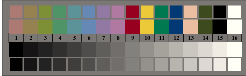
Bild B3: 14 CIE-Prüffarben sowie 2 + 16 Graustufen; PS-operator cmly0*/000n* setcmlycolor
