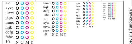
Bild B5: Schrift und Landoltringe N, M, C und Y; PS-Operator cmY0*/000n* setcmYcolor
