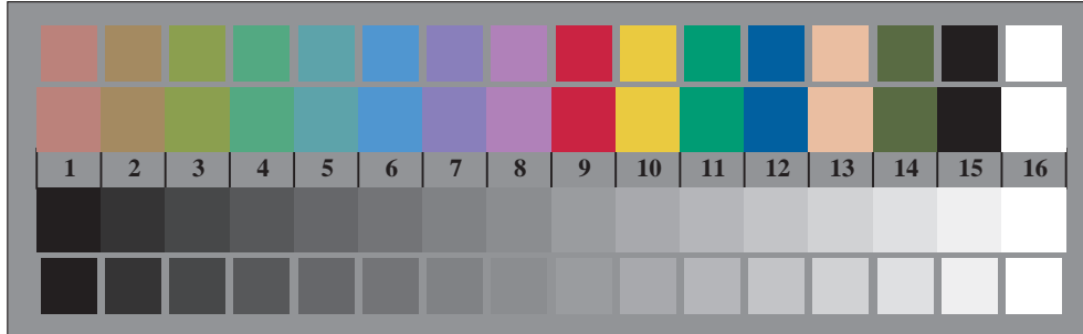
Bild B3: 14 CIE-Prüfbarben sowie 2 + 16 Graustufen; PS-Operator olv* setrgbcolor / w* setgray
