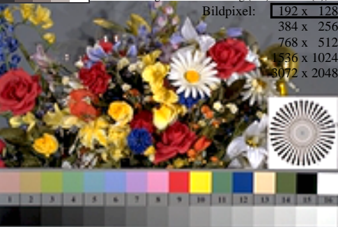
Bild B4: 16 gleichabständige Stufen W-C, W-M, W-Y und W-N; PS-Oper. olv* setrgbcolor / w* setgray
