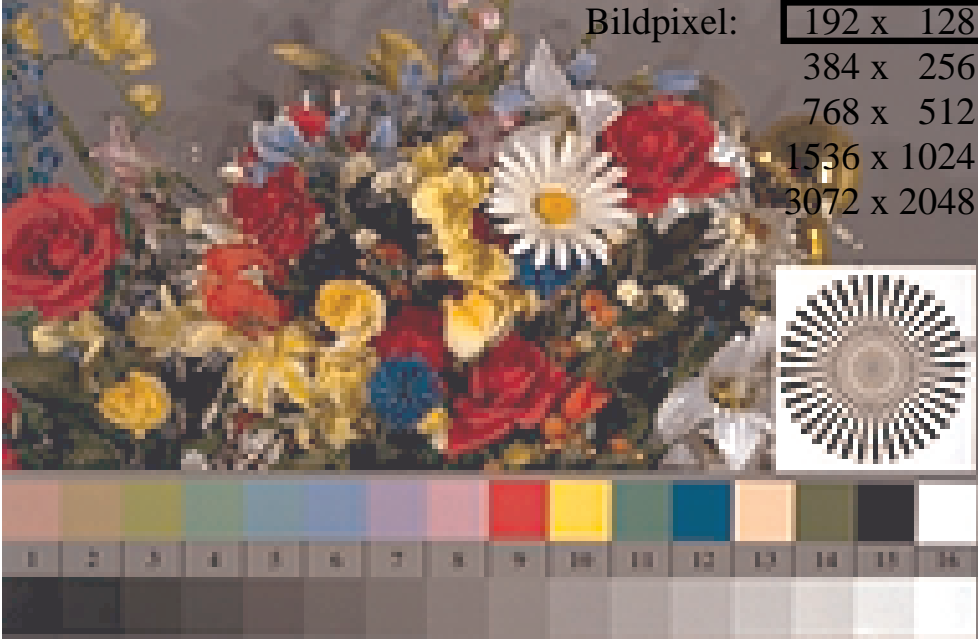
Bild D1: Blumenmotiv, 14 CIE-Prüfbarben sowie 2 + 16 Graustufen (nf); PS-Operatoren settransfer , 4 colorimage
