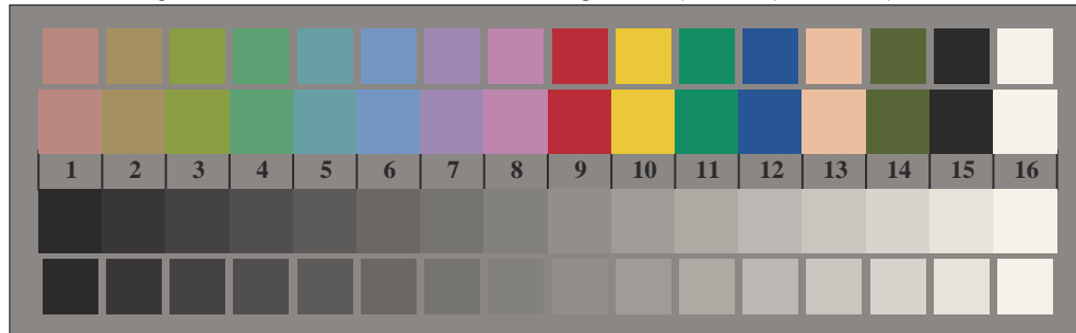
Bild D3: 14 CIE-Prüfbarben sowie 2 + 16 Graustufen; Benutzung des PS-operators cmY0* setmykcolor (only)
