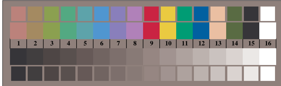
Bild D3: 14 CIE-Prüfbarben sowie 2 + 16 Graustufen; Benutzung des PS-operators cmY0* setmykcolor (only)
