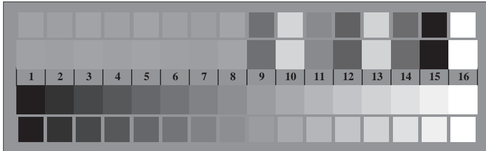
Bild D3: 14 CIE-Prüfbarben sowie 2 + 16 Graustufen; PS-Operator olv* setrgbcolor (only)
