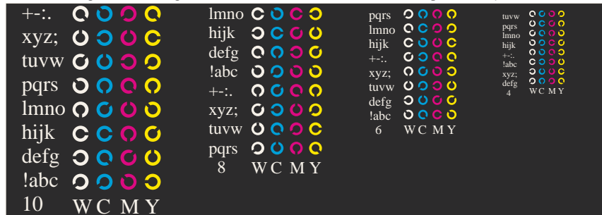
Bild B5n: Schrift und Landoltringe W, M, C und Y; PS-Operator cm\gamma 0^* / 000n^* setcmykcolor
