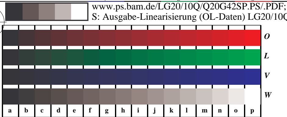
Bild D4n: 16 gleichabständige Stufen N-O, N-L, N-V und N-W; PS-Operator cmY0* setcmYcolor (only)
