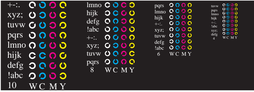
Bild B5n: Schrift und Landoltringe W, M, C und Y; PS-Operator cmy0^* / 000n^* setcmykcolor
