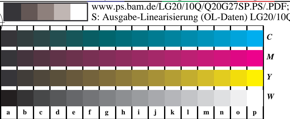
Bild B4n: 16 gleichabständige Stufen N-C, N-M, N-Y und N-W; PS-Operator cmY0*/000n* setcmykcolor
