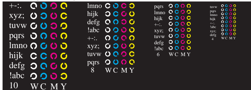
Bild B5n: Schrift und Landoltringe W, M, C und Y; PS-Operator olv* setrgbcolor / w* setgray
