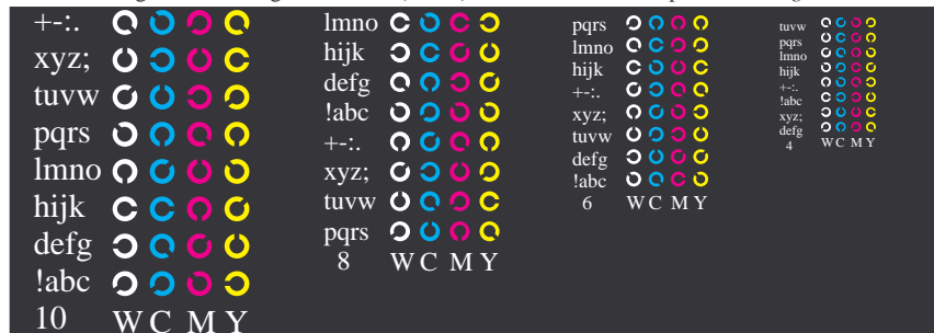
Bild B5n: Schrift und Landoltringe W, M, C und Y; PS-Operator olv* setrgbcolor / w* setgray
