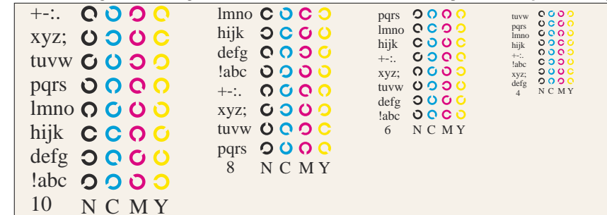
Bild B5w: Schrift und Landoltringe N, M, C und Y; PS-Operator olv* setrgbcolor (only)
