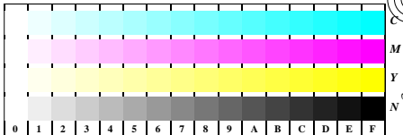
Bild B4w: 16 gleichabständige Stufen W-C, W-M, W-Y und W-N; PS-Oper. olv* setrgbcolor (only)
