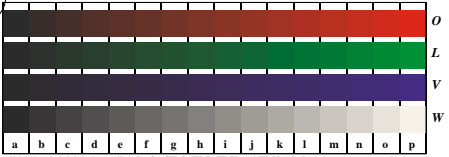
Bild D4n: 16 gleichabständige Stufen W-O, W-L, W-V und W-N; PS-Operator LAB* setcolor
