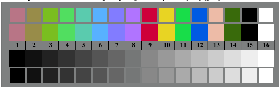
AF260-7, Fig. B3Wdd: 14 CIE test couleurs et 2 + 16 paliers de gris (sf); rgb/cmy0 \rightarrow rgb_{dd} setrgbcolor
