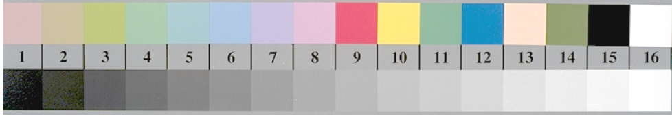
AF270-3, Fig. B1Wde: motif fleuri, 14 CIE test couleurs et 2 + 16 paliers de gris (nf); PS opérateur : settransfer, 3 colorimage
