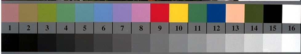
AF280-3, Fig. B1Wdd: motif fleuri, 14 CIE test couleurs et 2 + 16 paliers de gris (nf); PS opérateur : settransfer, 3 colorimage
