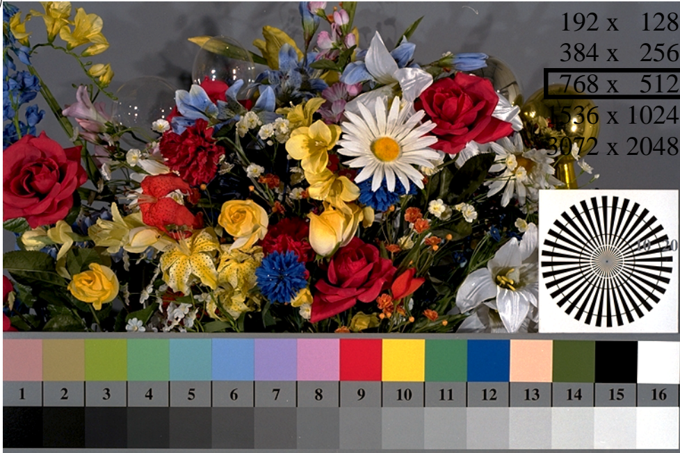
AF280-3, Fig. B1Wdd: motif fleuri, 14 CIE test couleurs et 2 + 16 paliers de gris (nf); PS opérateur : settransfer, 3 colorimage
