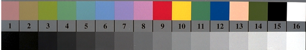
AF280-3, Fig. B1Wdd: motif fleuri, 14 CIE test couleurs et 2 + 16 paliers de gris (nf); PS opérateur : settransfer, 3 colorimage
