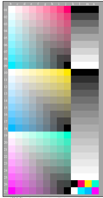
AF560-71 La partie de graphique AF56 de test avec 1080 couleurs; paliers de 9 ou 16 couleurs; les données de la colonne (b-n): rgb 3-110110-L0 cmy6*
