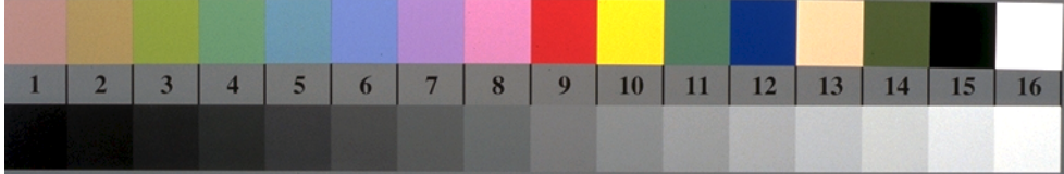
AN180-3, Figur D1Wdd: Flower motif, 14 CIE-test colours og 2 + 16 gråtrinn (sf); PS operator: settransfer , 3 colorimage
