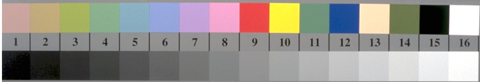
AN180-3, Figur D1Wdd: Flower motif, 14 CIE-test colours og 2 + 16 gråtrinn (sf); PS operator: settransfer , 3 colorimage
