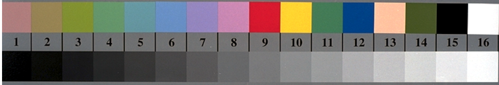
AN270-3, Figur B1Wde: Flower motif, 14 CIE-test colours og 2 + 16 gråtrinn (nf); PS operator: settransfer , 3 colorimage
