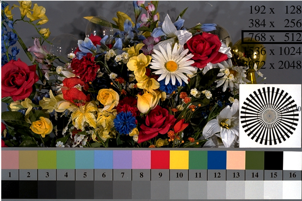
AN280-3, Figur B1Wdd: Flower motif, 14 CIE-test colours og 2 + 16 gråtrinn (nf); PS operator: settransfer , 3 colorimage
