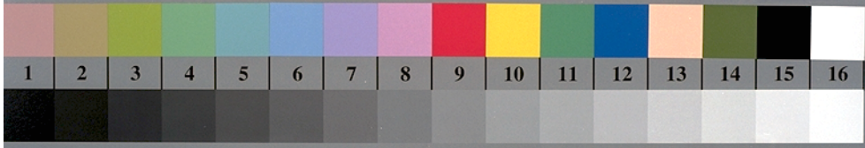
AN280-3, Figur B1Wdd: Flower motif, 14 CIE-test colours og 2 + 16 gråtrinn (nf); PS operator: settransfer , 3 colorimage
