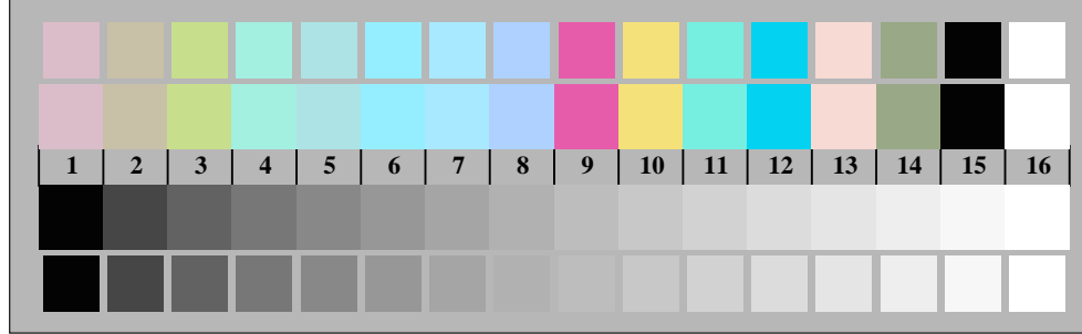
AS160-7, fig. D3Wde: CIE 14 colores del test y 2 + 16 pasos de gris (sf); rgb/cmy0 \rightarrow rgb_{de} setrgbcolor
