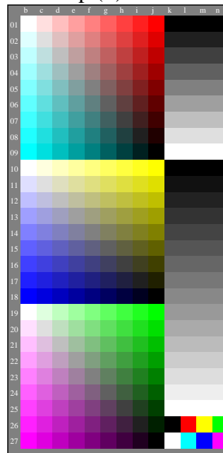
AS590-71 Parte del gráfico de prueba AS59 con 1080 colores; escalas de colores de 9 o 16 pasos; los datos en la columna (b-n): rgb
