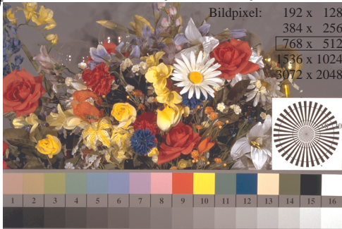
Fg040-3, Bild B1: Blumenmotiv, 14 CIE-Prüffarben, 16 Graustufen (sf); PS-Operatoren settransfer, 4 colorimg
