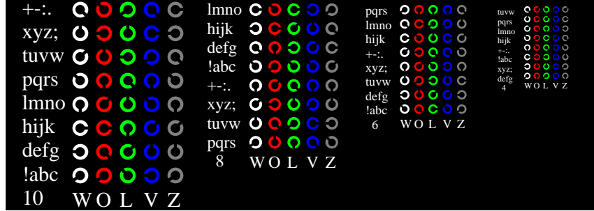
Fg480-3, Bild D5N: Schrift und Landoltringe W, O, L, V, Z; PS-Operator olv* setrgbcolor
