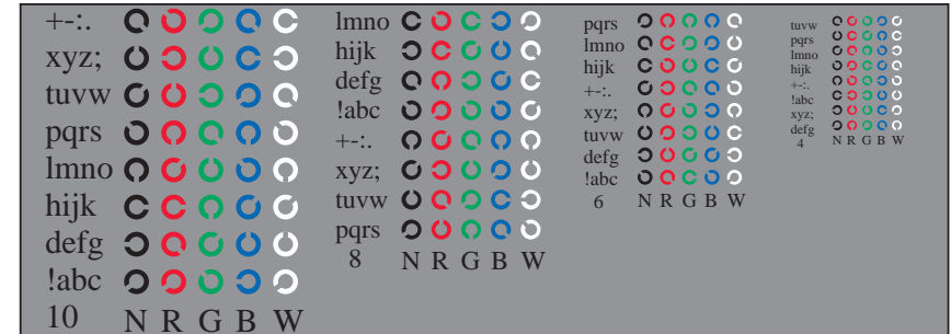
Fg481-3, Bild D5Z: Schrift und Landoltringe N, R, G, B, W; PS-Operator rgb* setrgbcolor
