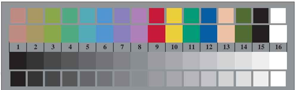
Fg490-7, Bild B3: 14 CIE-Prüffarben sowie 2 + 16 Graustufen; PS-Operator olv* setrgbcolor
