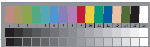
Fg490-7, Bild B3: 14 CIE-Prüffarben sowie 2 + 16 Graustufen; PS-Operator olv* setrgbcolor
