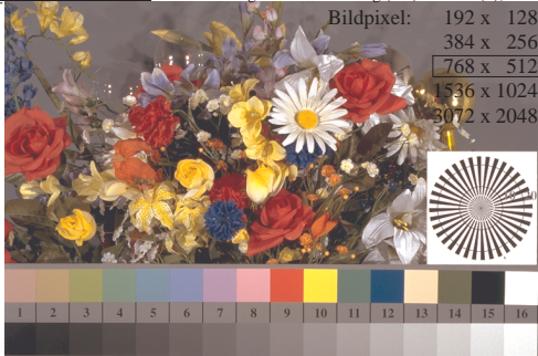
Fg490-3, Bild B1: Blumenmotiv, 14 CIE-Prüffarben, 16 Graustufen (sf); PS-Operatoren settransfer , 4 colorimg
