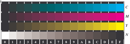
IG810-1, Bild B4N: 16 gleichabständige Stufen N-C, N-M, N-Y, W-N; PS-Operator olv* setrgbcolor
