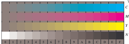
IG811-1, Bild B4Z: 16 gleichabständige Stufen Z-C, Z-M, Z-Y, W-N; PS-Operator olv* setrgbcolor
