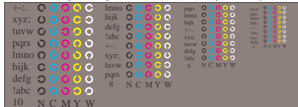
IG811-3, Bild B5Z: Schrift und Landoltringe N, C, M, Y, W; PS-Operator olv* setrgbcolor
