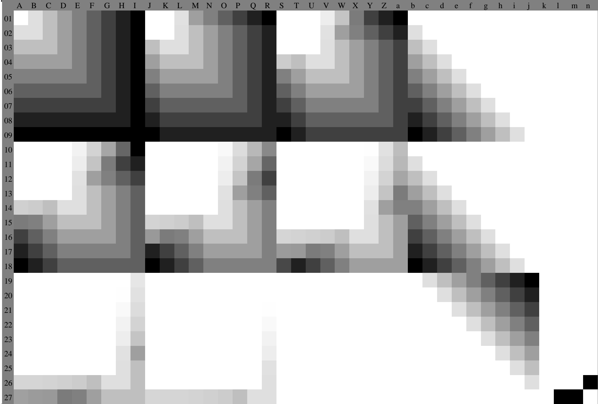
LG880-7N, 8/11, Prüfvorlage G mit 40x27=1080 Farben; digital gleichabständige 9 oder 16stufige Farbreihen; Farbdaten in Spalte (A-n): c^* (A_n), colorm = 1, separation = C, cmyn5*
