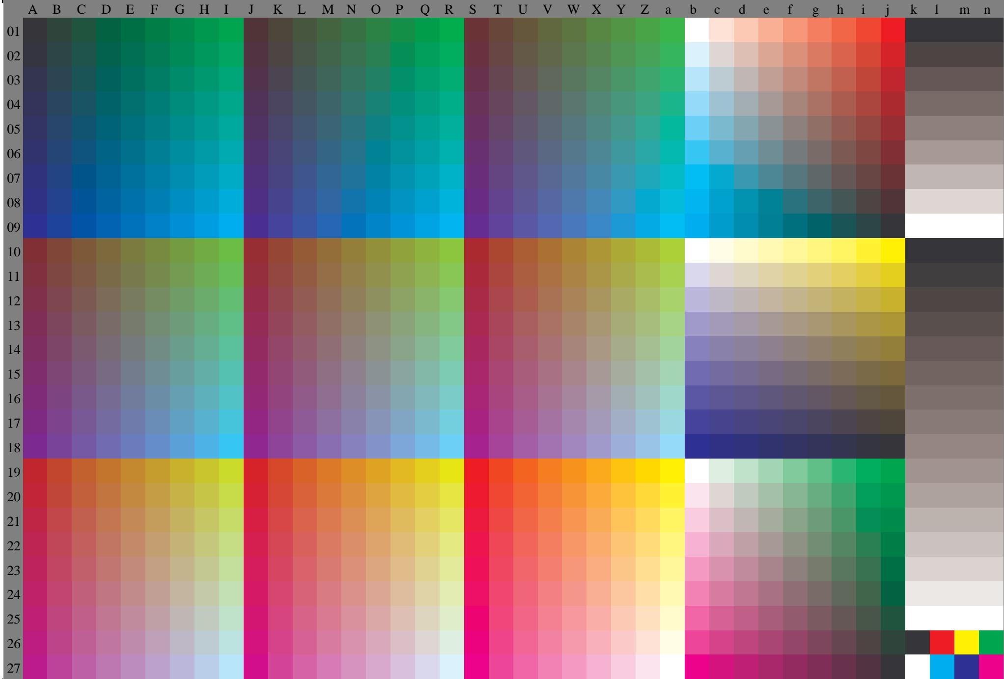
LG880-7N, 6/11, Prüfvorlage G mit 40x27=1080 Farben; digital gleichabständige 9 oder 16stufige Farbreihen; Farbdaten in Spalte (A-n): cmY0 (A_n), colorm = 0, separation = F
