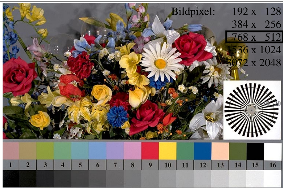
OG570-7, Bild B1-000-0: Blumenmotiv, 14 CIE-Prüffarben und 2 + 16 Graustufen (sf); PS-Operatoren settransfer, 3 colorimage
