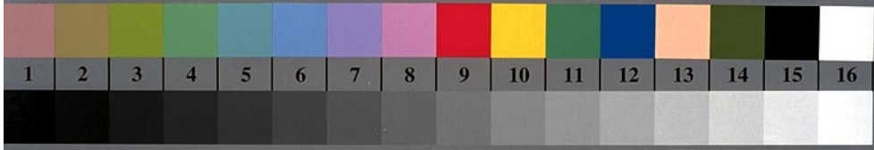
OG570-7, Bild B1-130-3: Blumenmotiv, 14 CIE-Prüffarben und 2 + 16 Graustufen (nf); PS-Operatoren settransfer, 3 colorimage
