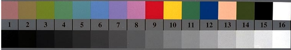
OG570-7, Bild B1-130-4: Blumenmotiv, 14 CIE-Prüffarben und 2 + 16 Graustufen (nf); PS-Operatoren settransfer , 3 colorimage
