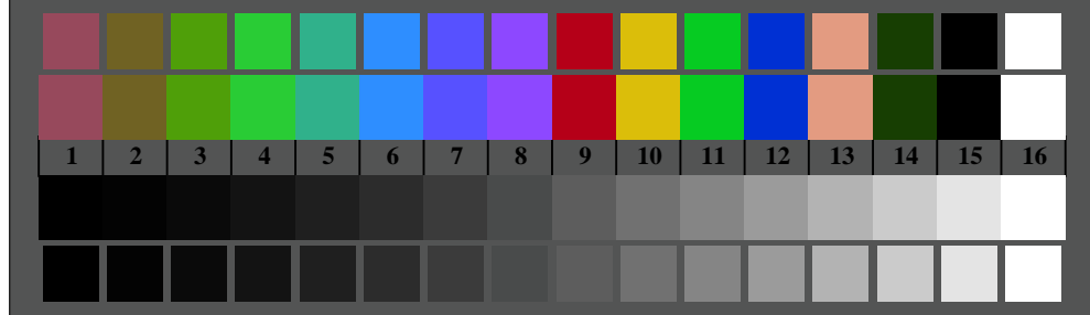
OG570-7, Bild B3W-130-5: 14 CIE-Prüffarben sowie 2 + 16 Graustufen; PS-Operator ->rgb d setrgbcolor
