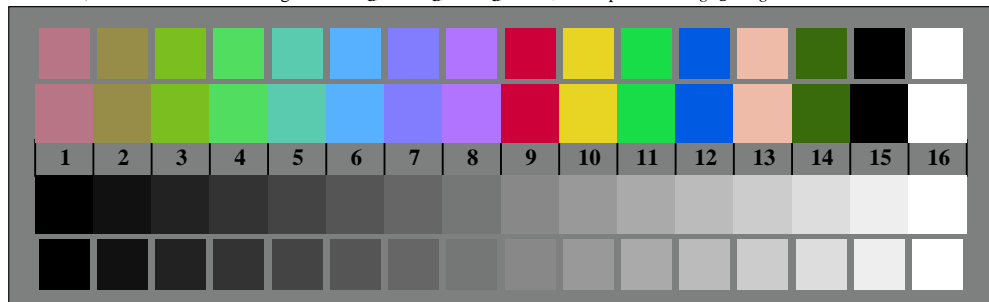
OG570-7, Bild B3W-130-0: 14 CIE-Prüffarben sowie 2 + 16 Graustufen; PS-Operator ->rgb d setrgbcolor
