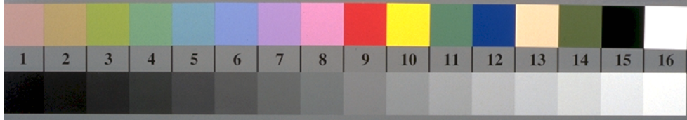
OG580-7, Bild D1W-030-0: Blumenmotiv, 14 CIE-Prüffarben und 2 + 16 Graustufen (sf); PS-Operatoren settransfer , 3 colorimage
