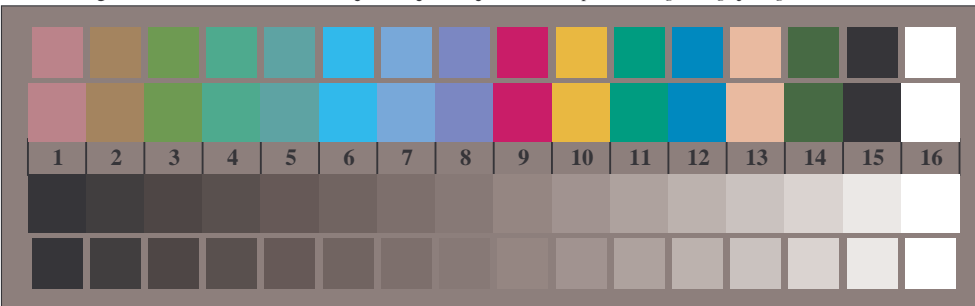
TF880-7, Fig. D3We: 14 CIE test couleurs et 2 + 16 paliers de gris (sf); PS opérateur: rgb/cmy0 \rightarrow rgb_e setrgbcolor
