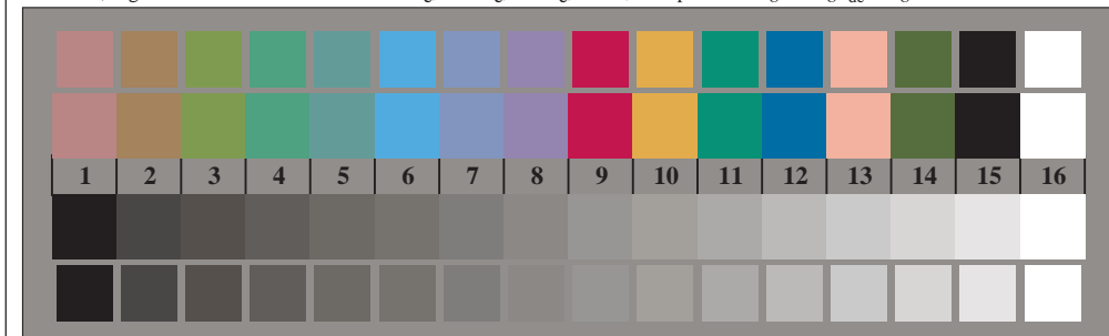
TF990-7, Fig. B3Wde: 14 CIE test couleurs et 2 + 16 paliers de gris (sf); PS opérateur: rgb/cmy0 \rightarrow rgb_{de} setrgbcolor
